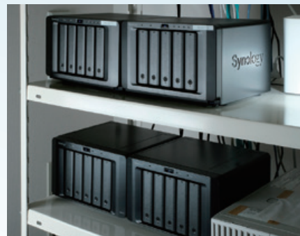
HAを組んだ2台のDiskStation DS1517+に、それぞれExpansion Unit DX517が増設されている。
